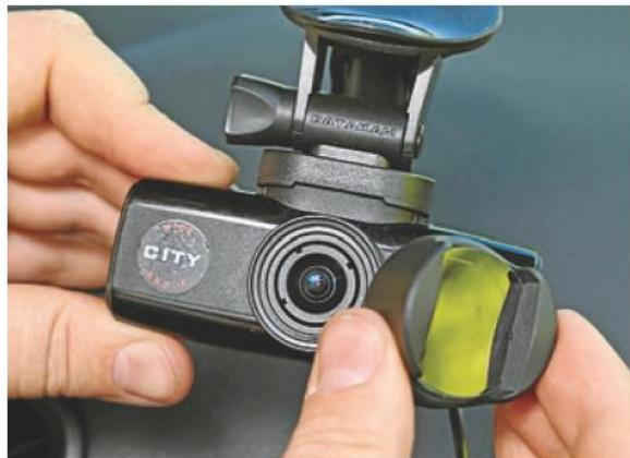
У Datakam предусмотрен съемный блендофильтер для уменьшения засветки. Ночью он помог прибору обойти соперников в статическом teste на читаемость номеров.
