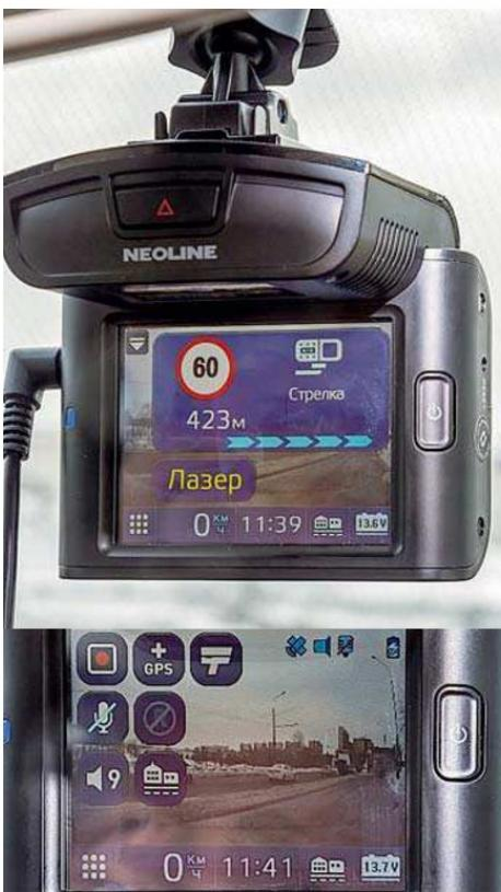
Тачскрину прибора Neoline немного не хватает яркости. Управление дополнительными функциями и меню интуитивно понятно – чувствуется, работали над эргономикой.
