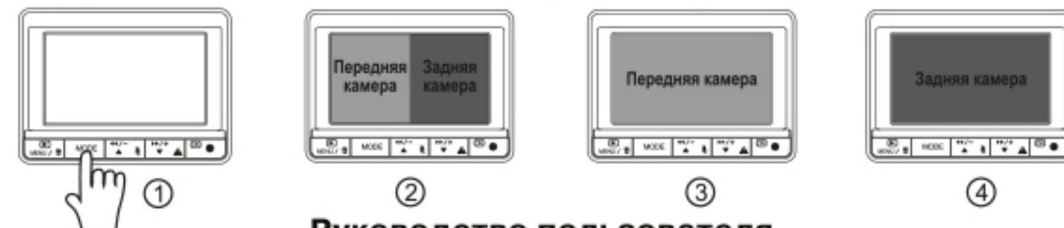
Выключение устройства производится длинным нажатием клавиши **Вкл./Выкл. питания**. Повторное включение – коротким нажатием клавиши **Вкл./Выкл. питания**.
