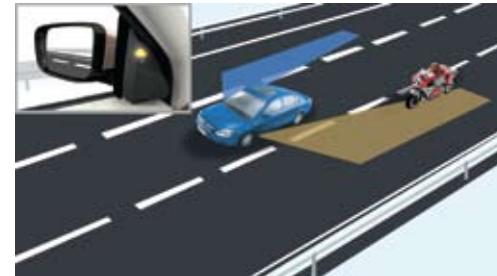
На самом деле применительно к автомобилю их две, слева и справа, и их конфигурация отличается друг от друга в зависимости от характеристик и положения зеркал заднего вида. Для контроля нахождения объектов (других транспортных средств) в этих «мёртвых» зонах используются системы, принцип работы которых может быть разным - с использованием радарных датчиков и без использования таковых.
